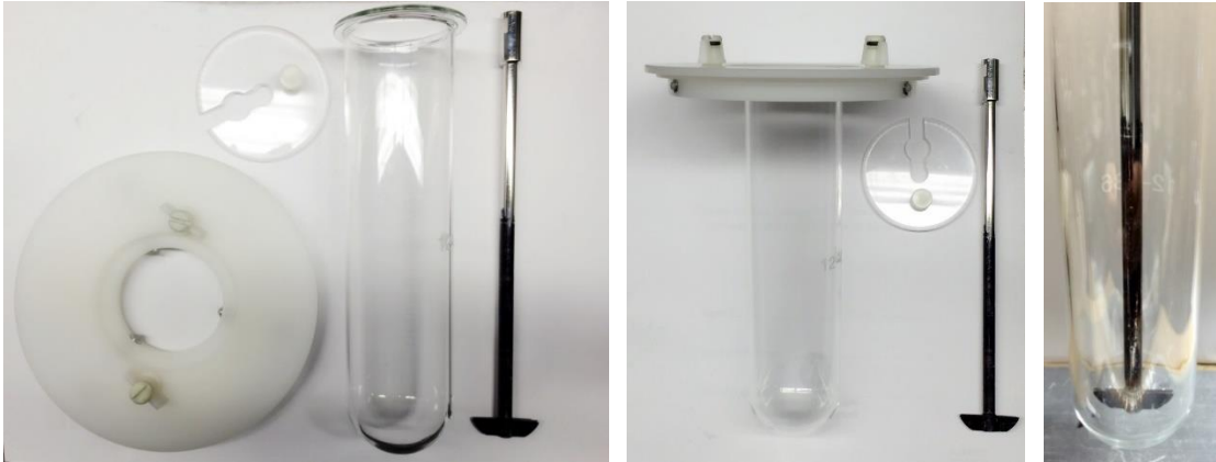
Figure 4.1 Mini vessel dissolution apparatus system, including mini vessel, mini paddle impeller and small lid.
