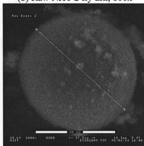
(d) Raw NJIT 2 fly ash, 2000x
